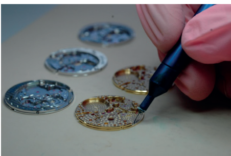
Pose de vernis
